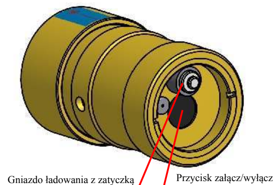
Rys. 2. Widok wskaźnika PGWL-1 z tyłu
